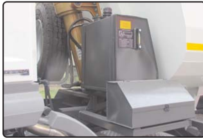
Hidrolik Tank, Takım Dolabı
